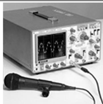
Un microphone relié à un oscilloscope
