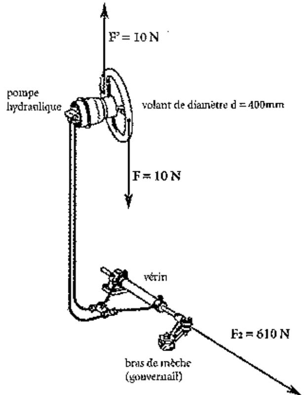
Figure 1 : schéma de la direction hydraulique manuelle d'un bateau avec moteur in-bord.
